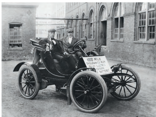
Рис. 2. Внешний вид электромобиля Эдисона на аккумуляторных батареях, 1910 г.
