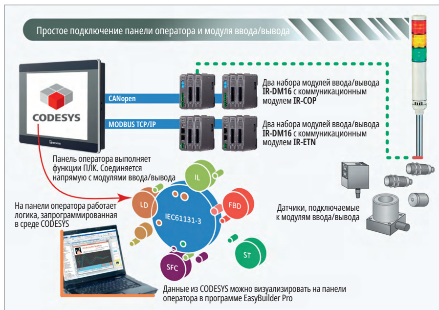
Рис. 5. Решение ЧМИ + CODESYS + система модулей ввода/вывода
