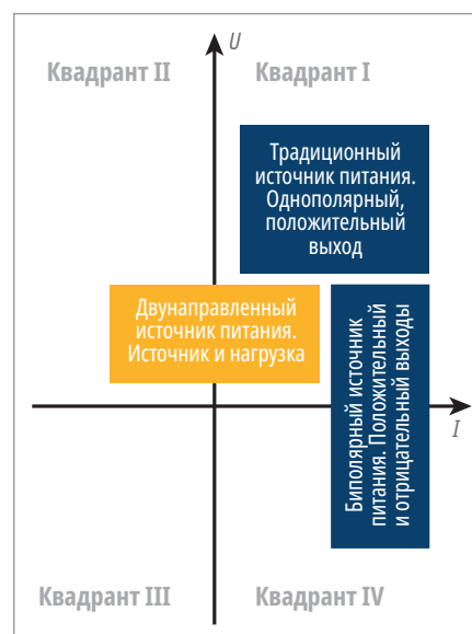
Рис. 2. Три типа источников питания постоянного тока
