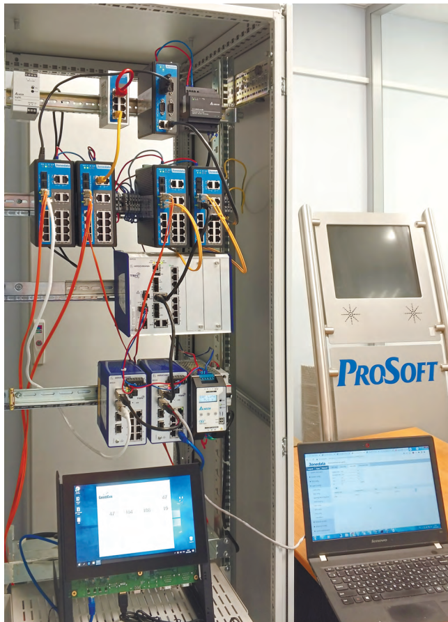
Рис. 5. Стенд для оценки работы оборудования в рамках протокола резервирования MRP
