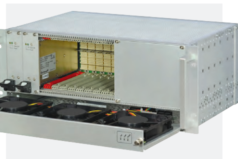
Рис. 5. Шасси для ММС стандарта CompactPCI Serial с резервированным блоком питания
