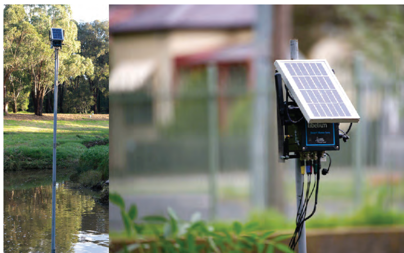
Рис. 3. Проактивная система мониторинга качества воды на основе измерительной платформы Waspmote Plug & Sense! в Австралии
