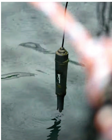
Рис. 4. Измерение параметров воды при помощи Plug&Sense! Smart Water
