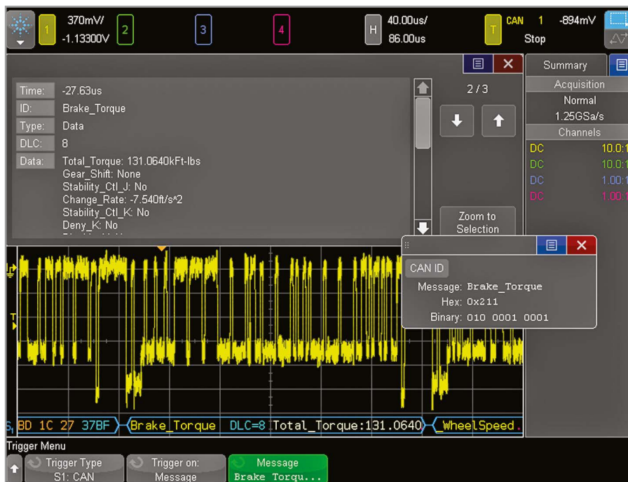
Рис. 2. Запуск по символам и декодирование данных шины CAN
