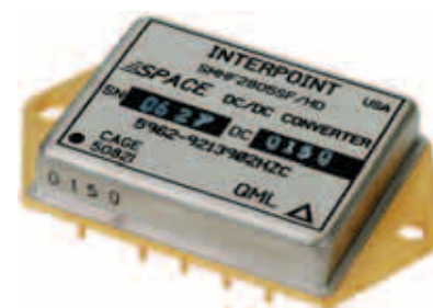
Рис. 1. Внешний вид микросхемы DC/DC-преобразователя серии SMHF (представлен вариант исполнения с крепёжным фланцем)
