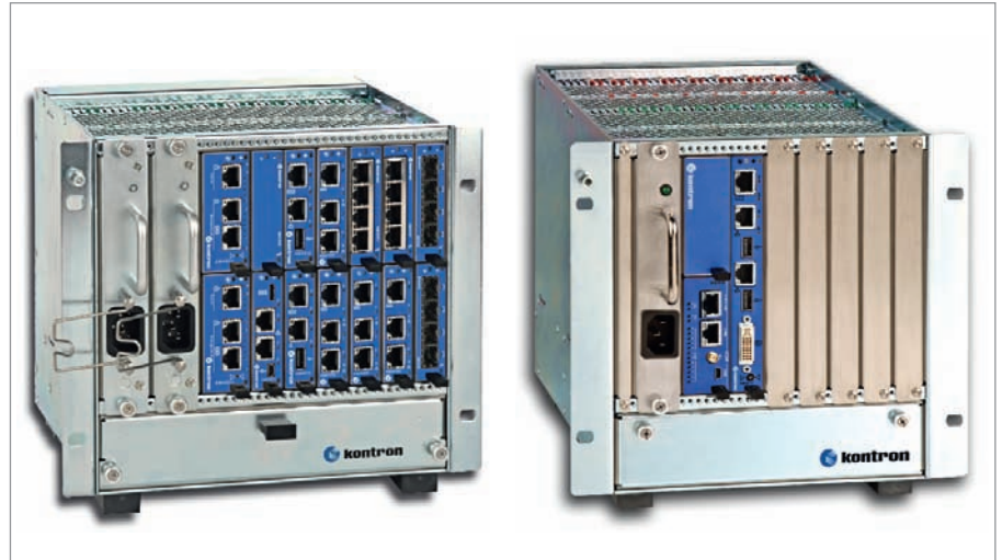
Рис. 1. MicroTCA-система OM6120 в крейте формата Cube
