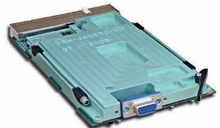
Рис. 2. Внешний вид одноплатного компьютера ITC-320 форм-фактора 3U CompactPCI
