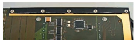
Рис. 3. Теплопроводящая окантовка, проходящая по границе печатной платы [2]
