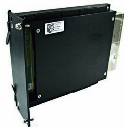
Рис. 7. Одноплатный компьютер F50C для использования в корпусе CPCI Rack
