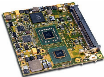
Рис. 6. Модуль microETXexpress-PC, оснащённый набором IC Intel GS45 SFF + ICH9M и поддерживающий высокопроизводительные процессоры Intel Core 2 Duo
