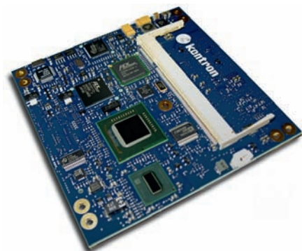
Рис. 5. Модуль microETXexpress-SP с системным контроллером-концентратором Intel SCH US15W, рассчитанный на процессоры серии Intel Atom Z5xx
