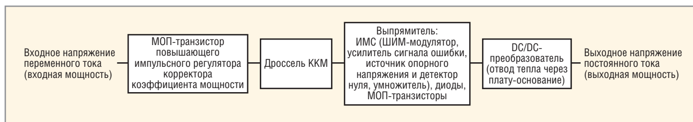
Рис. 2. Компоненты источника питания, выделяющие наибольшее количество тепла
