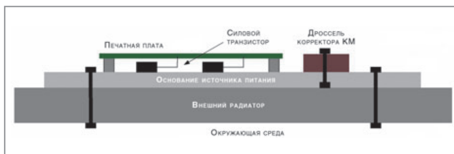
Рис. 3. Конструктивное оформление ИВЭП серии ВСС с основными выделяющими тепло компонентами, установленными на плате-основании
