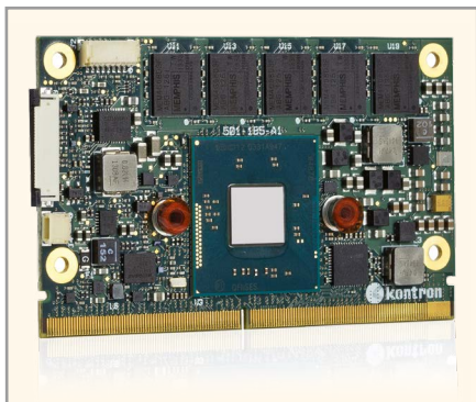
Рис. 5. Компьютеры-на-модуле серии Kontron SMARC-sXB7i рассчитаны на эксплуатацию при температурах от -40 до +85°C
