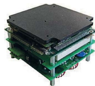
Рис. 2. Схема рассеивания тепла для систем на базе модулей PC/104
