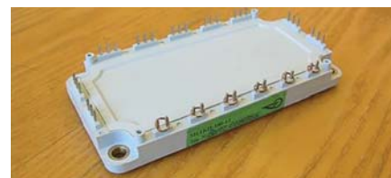
Силовой шестиключевой модуль в корпусе LoPak
