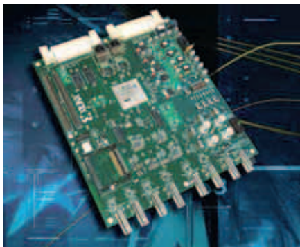
Рис. 1. Отладочно-демонстрационная плата ML571
