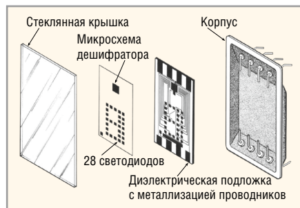
Рис. 1. Устройство светодиодного индикатора
