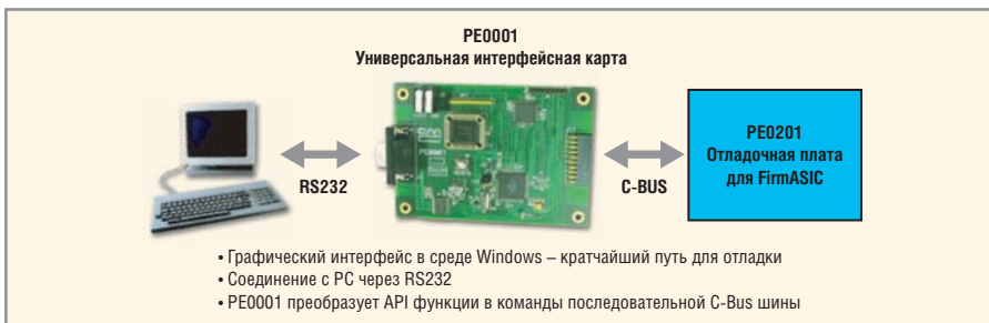
Рис. 2. Конфигурация отладочных плат для загрузки и отладки микросхемы с помощью компьютера
