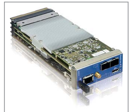
Рис. 5. MCH-контроллер AM4910 ориентирован на приложения с высокой интенсивностью обмена данными
