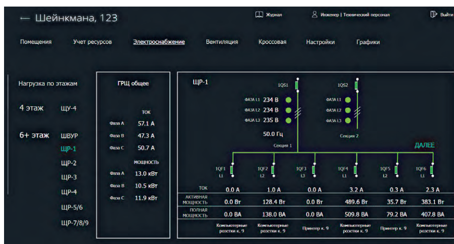
Рис. 2. Контроль системы электроснабжения
