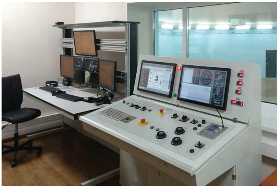
Рис. 10. Современное место оператора центрифуги Ц-30
