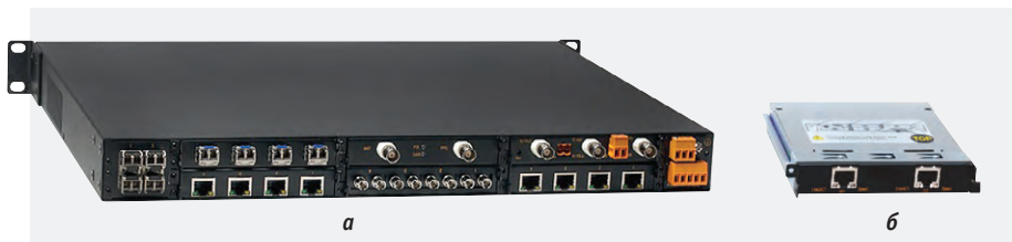
Рис. 8. Multifunctional modular platform Kyland SICOM3028GPT с поддержкой PRP, HSR, PTP: внешний вид (а); модуль SM6.6-HSR/PRP (б)
