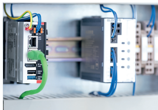
Рис. 2. С6015 осуществляет децентрализованное интеллектуальное управление и функции шлюза IoT, занимая минимальное пространство
