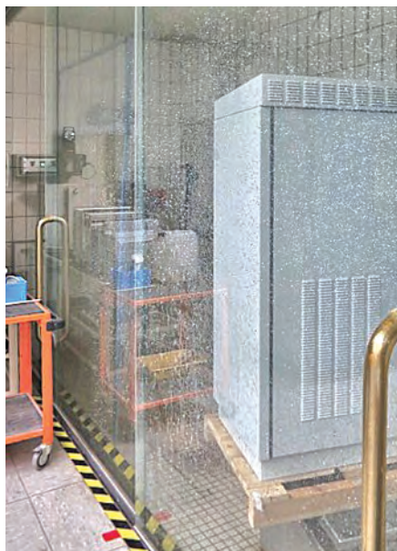
Рис. 12. Испытания шкафа на герметичность (степень защиты IP55)
