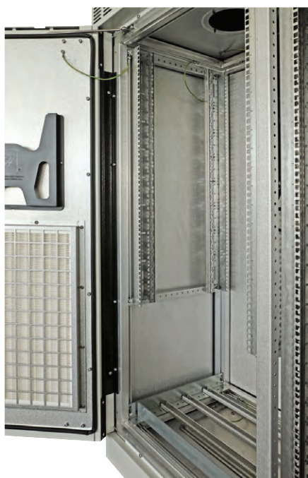
Рис. 13. Внутренняя часть модульного уличного шкафа nVent SCHROFF: алюминиевый каркас, двойные стенки, воздушный фильтр и клипсовые уплотнения на дверях, формовочные прокладки между рамой и внутренней стенкой для обеспечения степени защиты IP55
