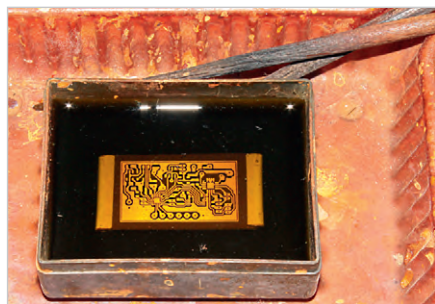
Рис. 23. Травление заготовки в хлорном железе
