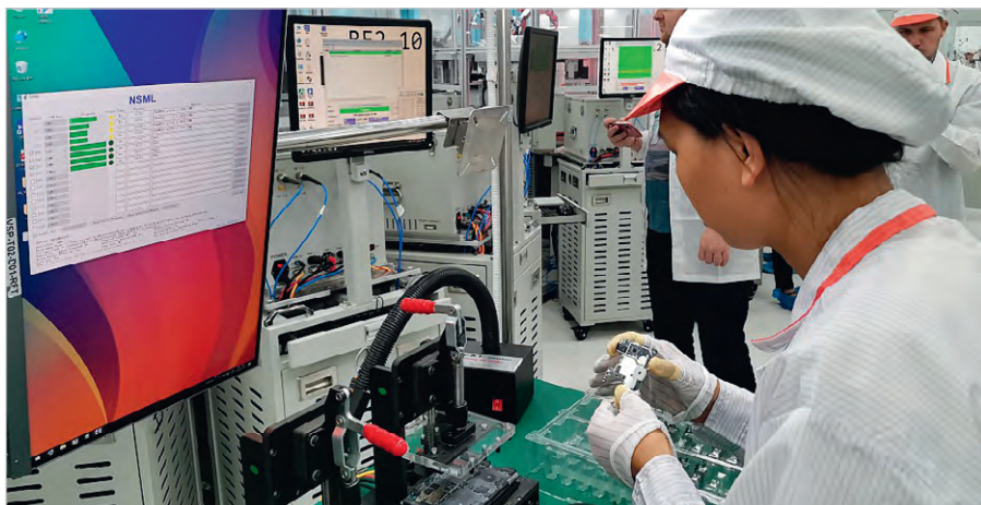
Рис. 4. Рабочее место сборщика РЭ-модулей
