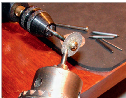
Рис. 34. Заточка керн на алмазном круге
