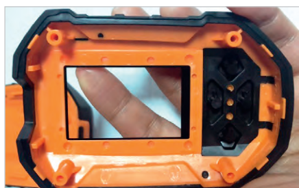
Рис. 4. Пример создания пластикового корпуса посредством ТПА
