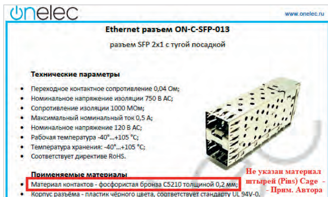
Рис. 12. Лист данных разъёма ON-C-SFP-013 российского поставщика компонентов «ОНЕЛЕК». Судя по совпадению обозначений разъёма в СЗ производственного отдела и данного листа данных, именно «ОНЕЛЕК» поставил исследуемый разъём
