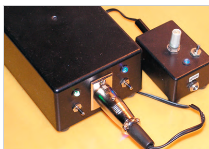
Рис. 32. Подключение линейного стабилизатора к блоку питания
