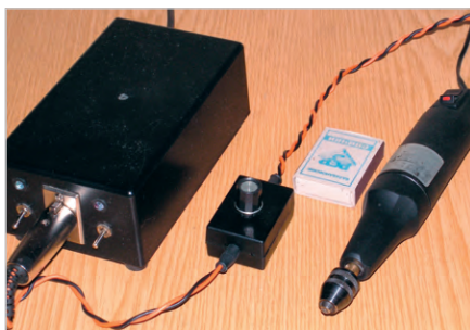
Рис. 33. Подключение тиристорного регулятора-стабилизатора к БП и дрели D-0600
