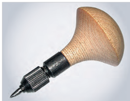
Рис. 24. Цанга с зажатым керном
