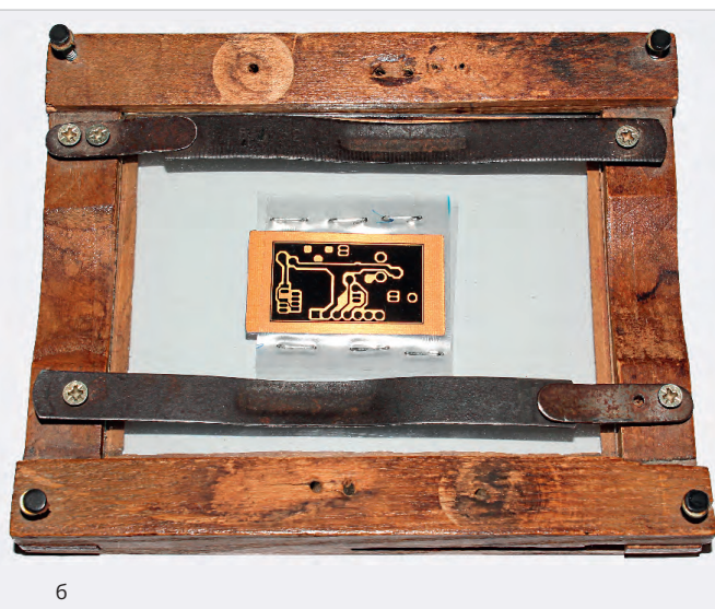
Рис. 18. Прижим фотошаблона к заготовке: а – вид со стороны расположения SMD-компонентов, б – вид с обратной стороны
