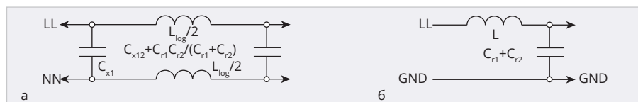
Рис. 4. Эквивалентная схема: а) для дифференциальной составляющей; б) для синфазной составляющей
