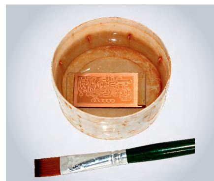
Рис. 22. Проявление заготовки в растворе «Крота»
