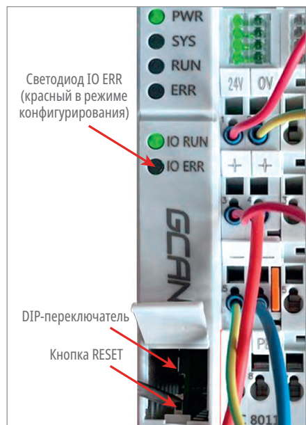
Рис. 11. Расположение кнопки «RESET» и DIP-переключателя на модуле GCAN-IO-8100
