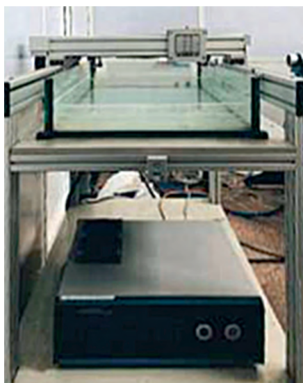
Рис. 2. Лабораторная установка для УЗК по методу DFA для контактного и бесконтактного контроля с трёхосевым манипулятором
