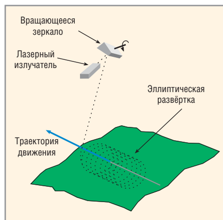
Рис. 4. Сканирующая система с вращающимся зеркалом
