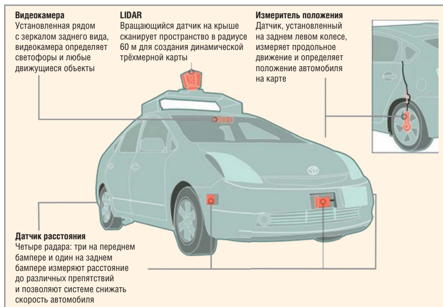
Рис. 6. Основные подсистемы беспилотного автомобиля Google
