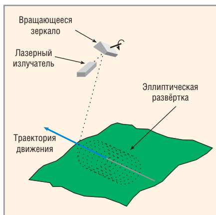
Рис. 4. Сканирующая система с вращающимся зеркалом
