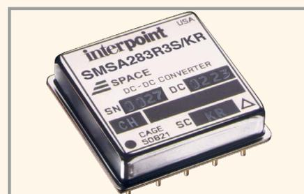
облучения нейтронами и протонами с разной степенью энергичности частиц. Компания Crane Aerospace & Electronics начала испытывать свои радиационно-стойкие DC/DC-преобразователи на неионизирующее радиационное воздействие с использованием нейтронов. Первыми подобное тестирование прошли 5-ваттные модули серии SMSA, которые планируется применить в космической миссии.
