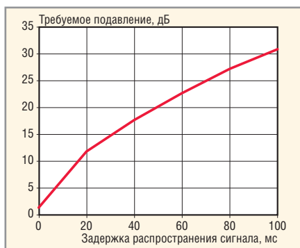
Рис. 11. Требуемое подавление эхо-сигнала
